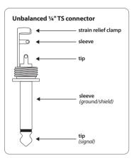
Fig. 2.3: Conector de altavoz TS de 6.3 mm
