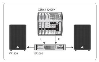
Fig. 5.1: Funcionamiento stereo de rango completo
