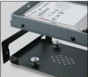
Disco Duro Interno con suspensión para golpes
