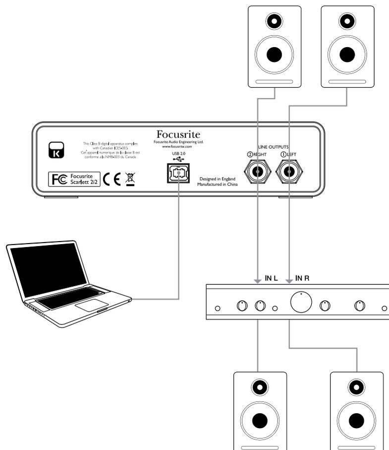
Todos los jacks de salida de línea son TRS de ¼" (6,35 mm) y están balanceados electrónicamente. Los amplificadores típicos (Hi-Fi) y pequeños monitores activos poseen entradas no balanceadas, por medio de conectores phono (RCA) o por medio de jacks estéreo de 3.5 mm, destinadas a su conexión directa en una computadora.
