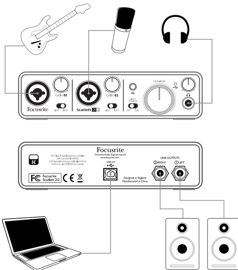
Esta configuración típica muestra las conexiones para grabar con la aplicación DAW en su Mac o PC. En este caso es posible grabar la guitarra a través de la entrada 1 y la voz a través de la entrada 2 en Cubase LE mientras monitoriza la reproducción desde la aplicación DAW a través de auriculares o altavoces.
