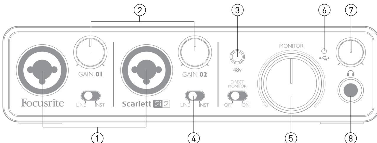
El panel frontal incluye conectores de entrada para señales de micrófono, línea e instrumentos, conector para auriculares y controles de ganancia de entrada y monitorización.
