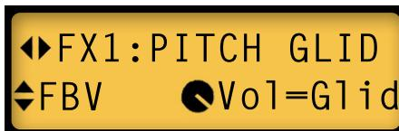
Cuando ajustes el parámetro “FBV” a “Vol= Glid” no controlarás el volumen con el pedal, puesto que lo controlará Pitch Glide. Si cambias a wah, el pedal controlará el wah como de costumbre, y el volumen siempre estará ajustado a “100%”.
