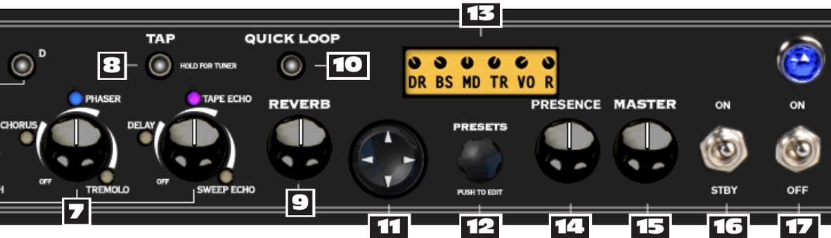
**7 Controles de los Smart FX** – Gira uno de estos 3 mandos para seleccionar fantásticos efectos, de manera fácil y rápida. Cada mando de efectos te permite seleccionar uno de los 3 modelos de efectos primarios o secundarios, con un total de 18 posibilidades, con hasta 3 modelos activos a la vez.
