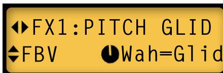
Cuando “Wah= Glid”, si desactivas el pedal wah, el pedal controlará el volumen, como de costumbre. Si activas el STOMP, el pedal de volumen volverá a cambiar a “Pitch Glide”. Sin embargo, siempre que utilices el conmutador STOMP, comprueba que el volumen del pedal está alto porque, una vez que “Pitch Glide” tome las riendas del pedal wah, no podrás ajustar el volumen, a menos que estés utilizando un pedal de expresión externo para el volumen.
