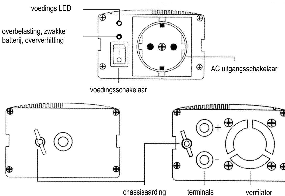
**Verleng de meegeleverde kabel niet! Dit kan tot te veel spanningsverlies leiden of de kabel oververhitten.**
