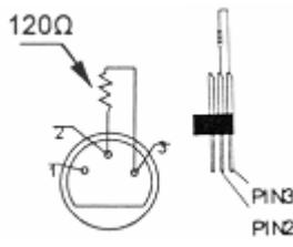
Een DMX eindweerstand is aanbevolen als de DMX-kabel vrij lang is of wordt gebruikt in een omgeving met veel elektrische ruis (bv. een discotheek). De eindweerstand voorkomt corruptie van het digitale controlesignaal door elektrische ruis. De DMX eindweerstand is niets meer dan een XLR-stekker met een weerstand van 120 Ω van pin 2 naar 3. Deze XLR-stekker wordt dan aangesloten op de XLR-uitgang van het laatste toestel in de reeks. Zie de illustraties links.
