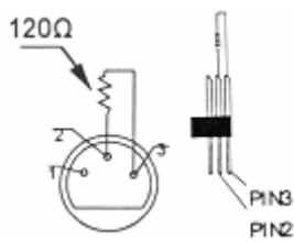
Es empfiehlt sich eine DMX-Terminierung wenn das DMX-Kabel eine große Distanz überbrücken muss oder in einer Umgebung mit vielem elektrischen Geräusch verwendet wird (z.B. Diskothek). Die Terminierung verhindert Korruption des digitalen Kontrollesignals durch elektrisches Geräusch. Die DMX-Terminierung ist nur ein XLR-Stecker mit einem Widerstand von 120Ω zwischen Pol 2 und Pol 3. Dieser XLR-Stecker wird dann in den XLR-Ausgang am letzten Gerät gesteckt. Siehe Abbildung links.
