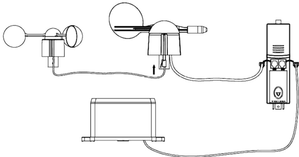
Wählen Sie einen geeigneten Ort und installieren Sie die Wetterstation (siehe Anweisungen oben). Berücksichtigen Sie die Himmelsrichtungen. Verbinden Sie das Anemometer mit der Wetterfahne. Verbinden Sie die Wetterfahne mit dem WIND-Anschluss des Thermo-Hygrometers und verbinden Sie das Pluviometer mit dem RAIN-Anschluss des Thermo-Hygrometers. Legen Sie schließlich 3 x AA-Batterien in das Batteriefach der Wetterstation ein. Beachten Sie die Polarität.
