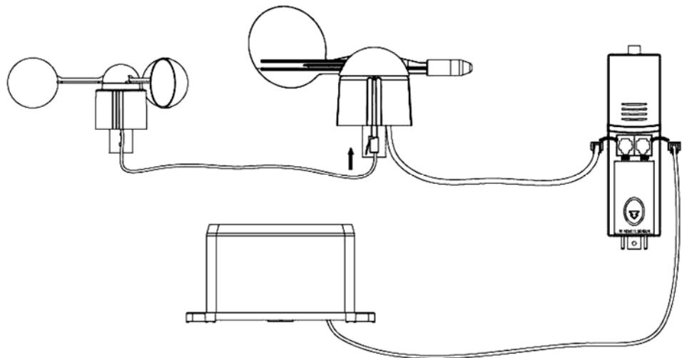
Installare l'unità esterna della stazione meteo in uno spazio aperto, lontano da alberi o altri ostacoli. Collegare il cavo dell'anemometro al connettore telefonico presente sotto la bandierola ed inserire il connettore di quest'ultima nella presa "WIND" presente nel pannello posteriore del termoigrometro. Collegare il sensore pioggia al connettore telefonico "RAIN" del termoigrometro, quindi inserire nell'unità 3 batterie formato AA rispettando la polarità.
