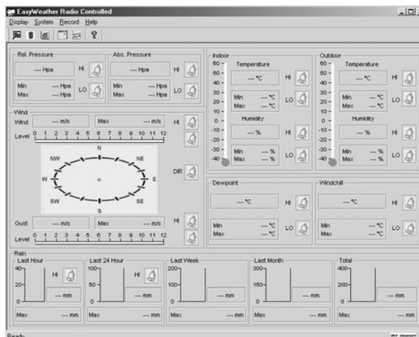
Alle instellingen van het ontvangststation verschijnen identiek in EasyWeather. Eens het ontvangststation ingesteld, hoeft dit in EasyWeather niet meer te doen. In EasyWeather kunt u echter, indien nodig, heel gemakkelijk de instellingen aanpassen. Deze aanpassingen worden dan automatisch in het ontvangststation opgeslagen.
