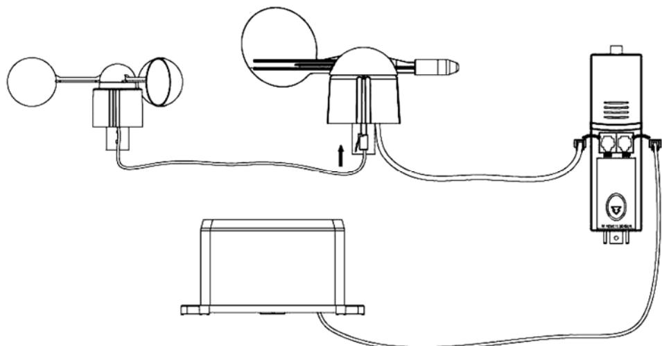
Instale la estación meteorológica en un lugar adecuado y tenga en cuenta los puntos cardinales. Conecte el anemómetro a la conexión de la veleta. Conecte la veleta a la conexión WIND del termo-higrómetro y conecte el pluviómetro a la conexión RAIN del termo-higrómetro. Finalmente, introduzca 3 pilas AA en la estación meteorológica. Respete la polaridad.
