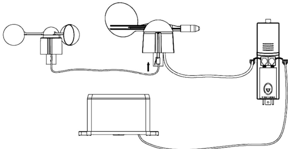
Installer la station météo à un endroit approprié en tenant compte des points cardinaux. Raccorder l'anémomètre à la prise de la girouette, raccorder la girouette à la prise WIND du thermo-hygromètre et raccorder le pluviomètre à la prise RAIN du thermo-hygromètre. Enfin, insérer 3 piles type AA dans la station météo en respectant la polarité.
