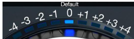
**Atenuación de micrófono:** los micrófonos pueden atenuarse hasta -20dB en pasos de 2dB. Los cambios en este ajuste afectarán a ambos micrófonos (1 y 2) simultáneamente. **El ajuste por defecto es -10dB.**
