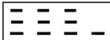
Maintenir enfoncé le bouton de la télécommande jusqu'à ce que l'afficheur clignote deux fois pour indiquer que les appareils sont synchronisés. Cela peut prendre jusqu'à 12 secondes.
