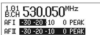
La sensibilidad de entrada está ajustada demasiado alta si, en caso de efecto anteboca, voz alta o pasajes de música altos, se producen sobremodulaciones en el tramo de transmisión. El transmisor y el receptor indican la sobremodulación en la pantalla.
