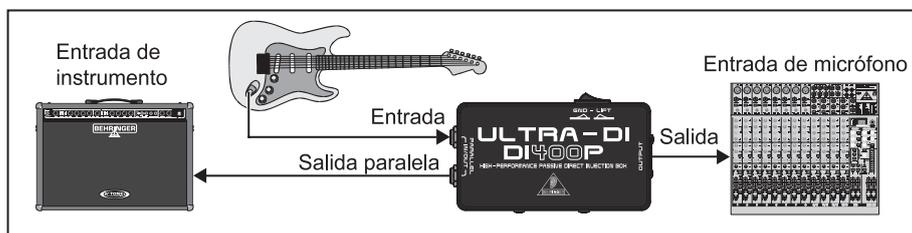
Fig. 2: Guitarra ➔ Caja de inyección directa ➔ Amplificador/mezclador
