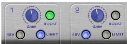
**Gain (ganancia):** Con este potenciómetro se controla la ganancia del preamplificador.
