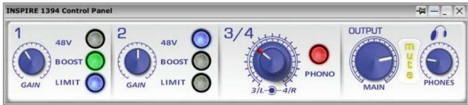
**Pantalla Win Shade:** En la ilustración superior puedes ver la configuración del modo Win Shade que es la versión reducida del panel de control de la interfaz INSPIRE 1394. Todos los controladores de esta pantalla funcionan de la misma forma que los controladores de la pantalla “Control Panel” Para cambiar de una pantalla a otra haz clic en el botón “Win Shade” como se explica en la sección 3.1.
