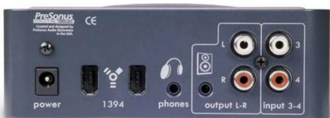
**a. Entrada para el adaptador de alimentación de 16VAC** Sirve para conectar la fuente de alimentación suministrada con la interfaz INSPIRE 1394. Comprueba que el voltaje de la fuente de alimentación esté configurado correctamente para tu país y que el tipo de enchufe sea el adecuado. Recuerda que la interfaz INSPIRE 1394 además de utilizar la fuente de alimentación externa también puede recibir la alimentación de corriente desde el puerto 1394 de seis pines de tu ordenador.
