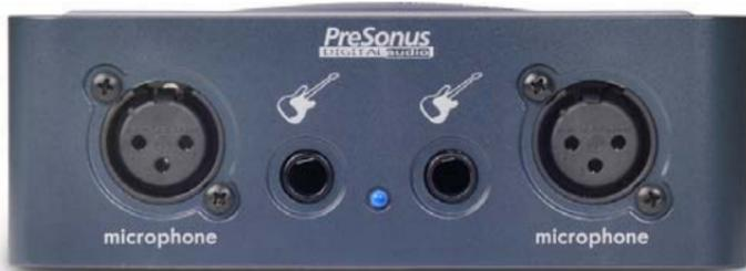
La interfaz INSPIRE 1394 está equipada con dos preamplificadores de estado sólido de diseño propio, controlados de forma digital y que aceptan conectores de entrada de micrófono XLR o de instrumento 1/4" jack. Sólo se puede utilizar un tipo de entrada (XLR o jack de 1/4") por preamplificador.
