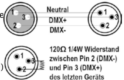
Bei längeren Kabelwegen ist es empfehlenswert, einen Endwiderstand zwischen Pin 2 und 3 zu löten, um Signalfehler zu vermeiden.
