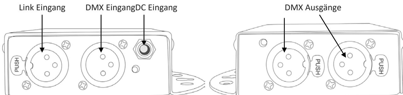
Das Gerät besitzt einen Eingang und zwei Ausgänge, die elektrisch isoliert sind.
