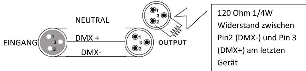
Der Endwiderstand verringert Signalfehler. Um Signalübertragungsprobleme und Störungen zu vermeiden, ist es ratsam, einen DMX Signalwiderstand zwischenzuschalten.
