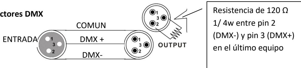
La resistencia de fin de línea reduce los errores de señal. Para evitar los problemas de transmisión de señal, siempre es recomendable conectar una resistencia al final de la línea DMX.
