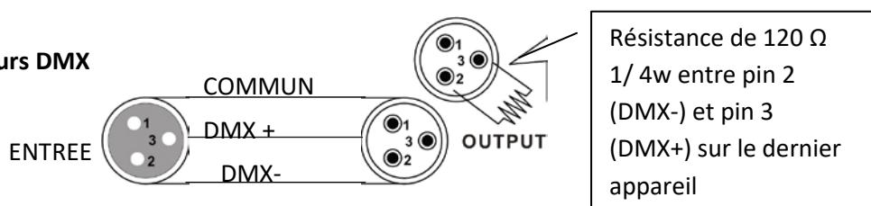
La résistance de fin de ligne réduit les erreurs de signal. Pour éviter des problèmes de transmission des signaux, il est toujours conseillé de brancher une résistance de fin de ligne DMX.
