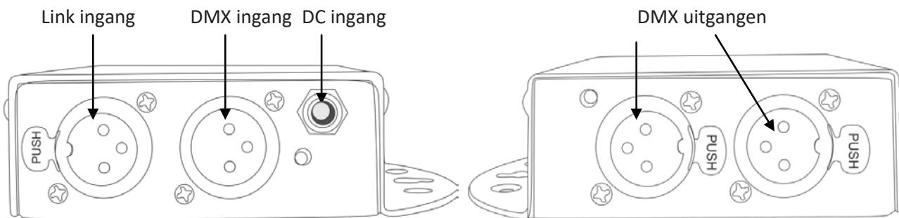
Het apparaat heeft een ingang en twee uitgangen die elektrisch zijn geïsoleerd.
