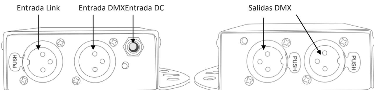
El splitter dispone de una entrada y de dos salidas que están aisladas electrónicamente.
