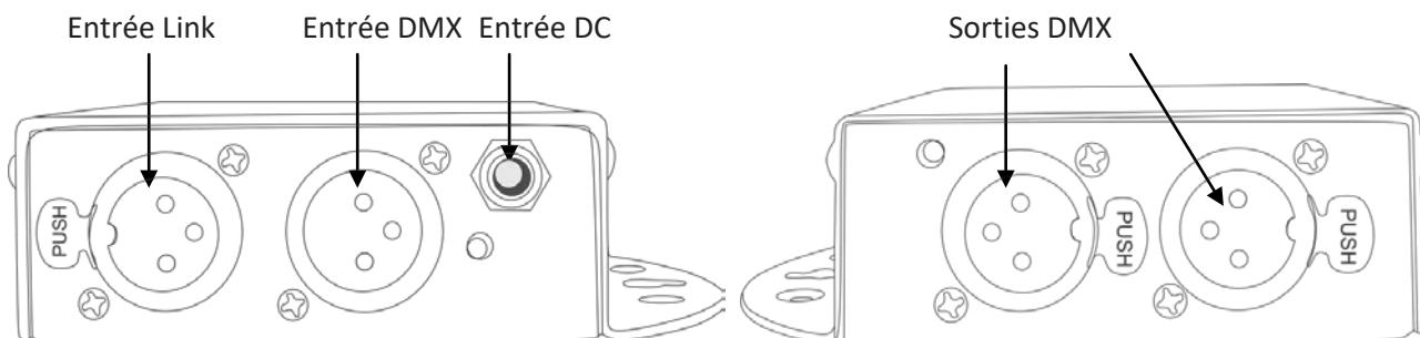
Le splitter dispose d'une entrée et de deux sorties qui sont électroniquement isolées.
