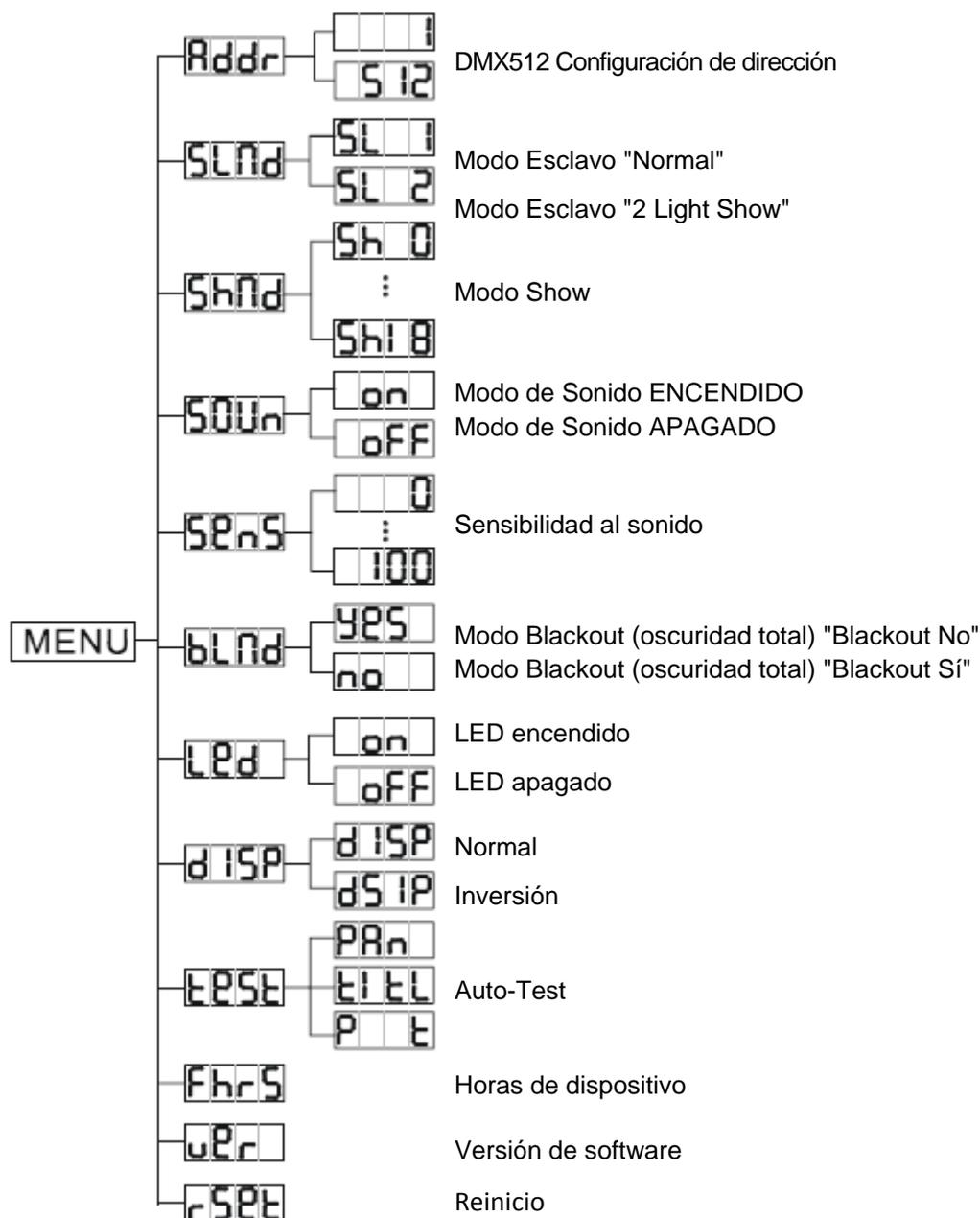
**Menú de Sistema:** Cuando confirme su configuración, pulse ENTER y luego mantenga pulsado MENU durante al menos 2-3 segundos, o bien puede esperar 1 minuto para la configuración automática. Para salir sin hacer ningún cambio, pulse el botón MENU.
