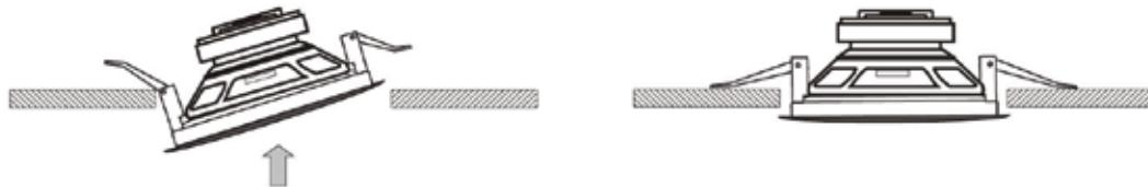
Schritt 1: Messen und markieren Sie das Einbauloch in der Decke. Bitte beachten Sie genau die angegebenen Maße der Bohrung. Wenn das Loch zu groß ist, vibriert der Lautsprecher möglicherweise.
