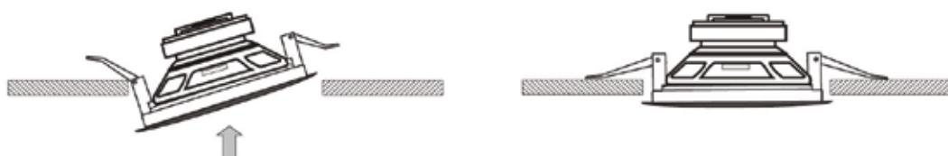
**Stap 1:** Meet en markeer het installatiegat in het plafond. Let op de exacte afmetingen van de boring. Als het gat te groot is, kan de luidspreker trillen.
