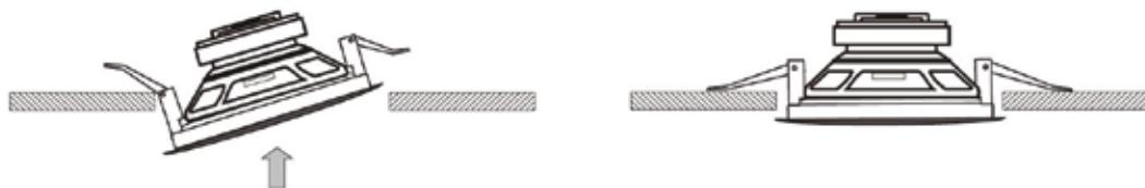
Etape 1: Avec un mètre, mesurez et tracez le trou à percer dans le plafond. Attention à bien respecter la dimension du trou de perçage indiqué. Un trou trop large pourrait faire vibrer le haut-parleur.
