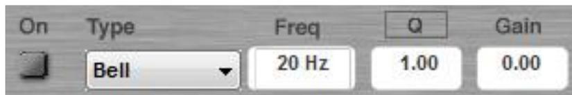
Ambos canales de entrada disponen de hasta 5 ecualizadores paramétricos. Cada uno de ellos se puede configurar con filtros All pass (todo paso), Bell (campana), High shelving (shelving alto), Low shelving (shelving bajo) o Notch (elimina banda).
