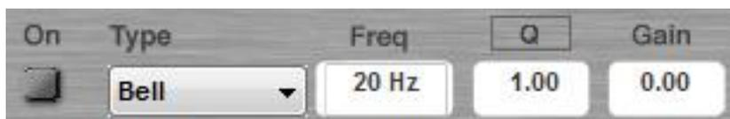
Ambos canales de entrada disponen de diez ecualizadores paramétricos. Cada uno de ellos se puede configurar con filtros All pass (todo paso), Bell (campana), High shelving (shelving alto), Low shelving (shelving bajo) o Notch (elimina banda).
