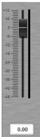
El fáder Gain (ganancia) muestra el ajuste de la ganancia. El cuadro de texto situado debajo del fáder Gain (ganancia) indica el valor exacto de la ganancia. El fáder Gain (ganancia) le permite ajustar la ganancia total de cada canal de salida. Ajuste la ganancia introduciendo el valor en el cuadro o haciendo clic y arrastrando el fáder.
