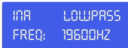
Ajústelo girando la **rueda de control (8)**. Puede desactivar el filtro de paso bajo girando la **rueda de control (8)** en sentido horario hasta que la frecuencia pase de los 20 kHz. Haga clic en la **rueda de control (8)** para cambiar el tipo de filtro.
