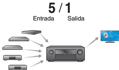
Esta unidad está equipada con 5 entradas HDMI y 1 salidas HDMI que permiten la conexión a varios dispositivos compatibles HDMI, como por ejemplo reproductores Blu-ray Disc, consolas de videojuegos y videocámaras de HD.
