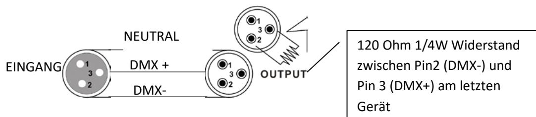
Der Endwiderstand verringert Signalfehler. Um Signalübertragungsprobleme und Störungen zu vermeiden, ist es ratsam, einen DMX Signalwiderstand zwischenzuschalten.
