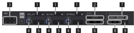
Modo sencillo: Se puede seleccionar un FX de tiempo de compás y un FX de liberación por unidad de efecto y cada FX de tiempo de compás tiene varios parámetros ajustables.
