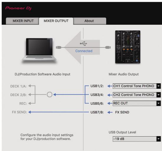
**4 Seleccione la pestaña [MIXER OUTPUT] de la utilidad de ajuste y después realice la selección tal y como se indica a continuación del menú desplegable [Mixer Audio Output] correspondiente al canal conectado.**
