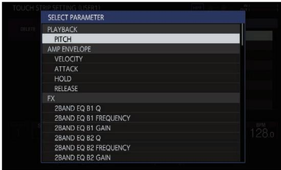
Si se selecciona el parámetro que se debe asignar con el selector giratorio y después se pulsa el selector giratorio, se asigna el parámetro. Se muestra el parámetro asignado.
