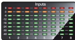
**Medidores de entrada.** Estos medidores LED muestran el nivel de entrada de las entradas analógicas de su interface Studio-series. El LED rojo de recorte se iluminará cuando la señal de entrada alcance los -0.5 dBFS. En este nivel, la señal comenzará a sobrecargar los convertidores analógico-a-digital y a mostrar signos de clipping o recorte. Use los controles de ganancia para mantener la señal por debajo de este nivel.
