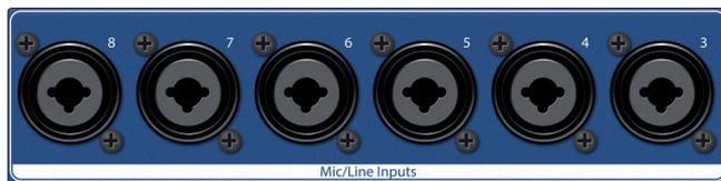
**Mic / Line Inputs (sólo en Studio 1824).** Las conexiones combo del panel posterior del Studio 1824 pueden usarse tanto para micrófonos como dispositivos de nivel de línea. Use las conexiones XLR para micrófonos y cajas de inyección directa (D.I. box) y las entradas TRS de 1/4 de pulgada para señales de nivel de línea de hasta +18 dBFS. El control trim del panel frontal ofrece ganancia para ambos tipos de entrada.
