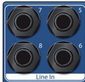
**Line Inputs (sólo en Studio 1810).** Use estas entradas TRS de 1/4 de pulgada con dispositivos de nivel de línea. Estas entradas están escaladas para aceptar las señales de nivel de línea de hasta +18 dBFS.
