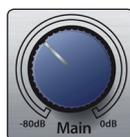
**Main.** El knob main controla el nivel de salida de las salidas principales left/right en la parte posterior de su interface Studio-series y tiene un rango de -80 dB a 0 dB. Este control proporciona solo atenuación.
