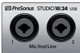
**Micrófono/Instrumentos/Entradas de línea.** Su interface Studio-series viene equipado con preamplificadores de micro PreSonus XMAX para usar con todo tipo de micrófonos. El XMAX dispone de un buffer de entrada Clase A, seguido de una etapa de ganancia servo dual. Esta disposición genera un ruido ultra bajo y un amplio control de ganancia, permitiéndole realzar las señales sin aumentar el ruido de fondo.
