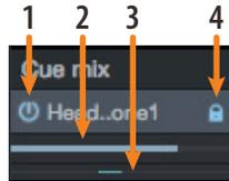
1. **Botón Activar.** Para eliminar completamente cualquier canal de una Z-Mix, sólo tiene que desactivar el objeto Z-Mix para ese canal. En la mayoría de los casos, siempre dejará esto activado.
