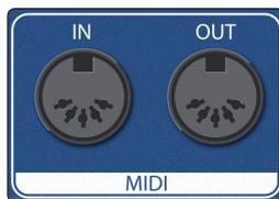
**Entrada y salida MIDI.** Las siglas MIDI representan el concepto "Musical Instrument Digital Interface." Las entradas y salidas MIDI permiten la conexión a, y la comunicación con, equipos externos MIDI. Una función de estos puertos es la secuenciación MIDI, pero el protocolo MIDI puede usarse para mucho más que instrumentos y secuenciación.
