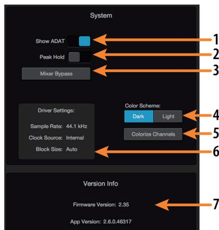
1. **Show ADAT.** Esto le ofrece la opción de mostrar sus entradas ADAT en su Mezclador UC Surface. Si no está conectando dispositivos externos a su entrada ADAT, puede desactivar esto para reducir el tamaño de sus mezclas de monitoraje y mostrar sólo las entradas que está usando.
