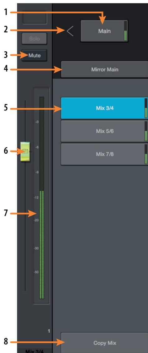
UC Surface le permite crear cuatro mezclas separadas de sus canales de entrada y cualquier retorno del DAW. Estas mezclas de baja latencia le ofrecen la capacidad de monitorizar sus entradas con una mínima latencia.
