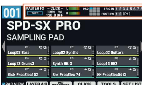
Se muestran varios ajustes en la parte superior de la pantalla. De izquierda a derecha: MASTER EFFECT, ajustes de clic, volumen MASTER OUT; los pads que se están editando, el conector TRIGGER IN y el conector FOOT SW se indican en azul.
