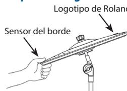
Si usa la mano para amortiguar (sujetar) el sensor del borde después de golpear el platillo, el sonido se detiene.
