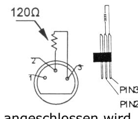
Ein DMX-Abschlusswiderstand ist empfehlenswert für Installationen, bei denen das DMX-Kabel lang ist oder in einer Umgebung mit vielem elektrischem Rauschen (z.B. Discos). Der Abschlusswiderstand verhindert Störung des digitalen Steuersignals durch elektrisches Rauschen. Der DMX-Abschlusswiderstand ist nur eine XLR-Buchse mit einem 120Ω Widerstand zwischen 2 und 3, die den XLR-Ausgang des letzten Geräts in der Kette angeschlossen wird. Siehe Abbildung links.
