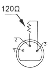
Se recomienda una terminación si el cable DMX debe cubrir una gran distancia o si se usa en un medio ambiente con mucho ruido eléctrico (ej. una discoteca). La terminación impide que el ruido eléctrico corrompa la señal de control numérico. La terminación DMX no es más que un conector XLR con una resistencia de 120Ω de polo 2 a polo 3. Este conector XLR está conectado a la salida XLR del último aparato de la serie. Véase la figura a la izquierda
