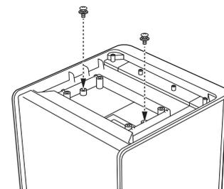
**6** Vuelva a colocar la tapa del compartimento de la batería y fíjela firmemente con los cuatro tornillos.
