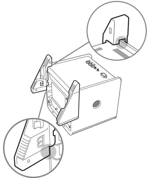
**4** Coloque la unidad con las patas de caucho en la parte inferior.
