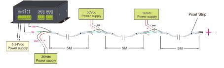
5.2 DMX wiring diagram.
