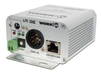
**LM 3E** es un conversor DMX a Ethernet que captura señales DMX y las transmite por la red Ethernet tanto con protocolo propio WORKNET como ArtNet. Su configuración de fábrica está diseñada para integrarse directamente en la red bajo ArtNet, de modo que no hace falta ninguna intervención por parte del usuario, aunque el sistema es totalmente configurable si, por ejemplo, se necesita cambiar la dirección IP del sistema.
