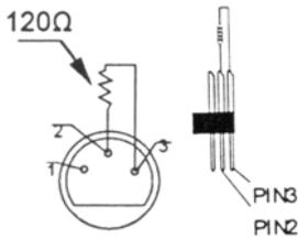
Se recomienda una terminación si el cable DMX debe cubrir una gran distancia o si se usa en un medio ambiente con mucho ruido eléctrico (ej. una discoteca). La terminación impide que el ruido eléctrico corrompa la señal de control numérico. La terminación DMX no es más que un conector XLR con una resistencia de  $120\Omega$  de polo 2 a polo 3. Este conector XLR está conectado a la salida XLR del último aparato de la serie. Véase la figura a la izquierda.
