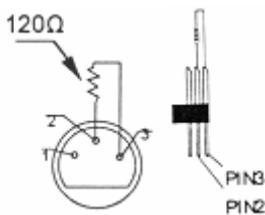
Es empfiehlt sich eine DMX-Terminierung wenn das DMX-Kabel eine große Distanz überbrücken muss oder in einer Umgebung mit vielem elektrischen Geräusch verwendet wird (z.B. Diskothek). Die Terminierung verhindert Korruption des digitalen Kontrollsignals durch elektrisches Geräusch. Die DMX-Terminierung ist nur ein XLR-Stecker mit einem Widerstand von  $120\Omega$  zwischen Pol 2 und Pol 3. Dieser XLR-Stecker wird dann in den XLR-Ausgang am letzten Gerät gesteckt. Siehe Abbildung links.
