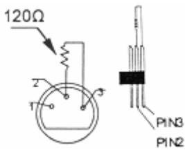
Een DMX eindweerstand is aanbevolen als de DMX-kabel vrij lang is of wordt gebruikt in een omgeving met veel elektrische ruis (bv. een discotheek). De eindweerstand voorkomt corruptie van het digitale controlesignaal door elektrische ruis. De DMX eindweerstand is niets meer dan een XLR-stekker met een weerstand van 120  $\Omega$  van pin 2 naar 3. Deze XLR-stekker wordt dan aangesloten op de XLR-uitgang van het laatste toestel in de reeks. Zie de illustratie links.
