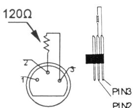
Se recomienda una terminación DMX si el cable DMX debe cubrir una gran distancia o si se usa en un medio ambiente con mucho ruido eléctrico (p.ej. una discoteca). La terminación impide que el ruido eléctrico corrompa la señal de control numérico. La terminación DMX no es más que un conector XLR con una resistencia de  $120\Omega$  de polo 2 a polo 3. Este conector XLR está conectado a la salida XLR del último aparato de la serie. Véase la figura a la izquierda.
