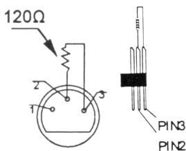
Une terminaison DMX est à recommander si le câble DMX doit couvrir une grande distance ou s'il est utilisé dans un environnement avec beaucoup de bruit électrique (p.ex. une discothèque). La terminaison prévient la corruption du signal de contrôle numérique par le bruit électrique. La terminaison DMX n'est rien d'autre qu'une fiche XLR avec une résistance de 120Ω de broche 2 vers broche 3 (voir illustration à gauche). Cette fiche XLR est connectée à la sortie XLR du dernier appareil de la série.
