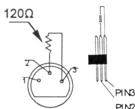
Een DMX terminator is aanbevolen als de DMX-kabel vrij lang is of wordt gebruikt in een omgeving met veel elektrische ruis (bvb. een discotheek). De terminator voorkomt corruptie van het digitale controlesignaal door elektrische ruis. De DMX terminator is niets meer dan een XLR-stekker met een weerstand van 120Ω van pin 2 naar 3. Deze XLR-stekker wordt dan aangesloten op de XLR uitgang van het laatste toestel in de reeks. Zie de illustraties links.
